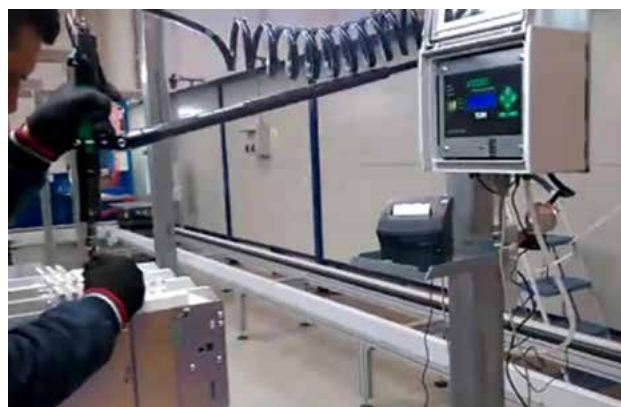
Processo sotto controllo e stampa esiti avvitature
